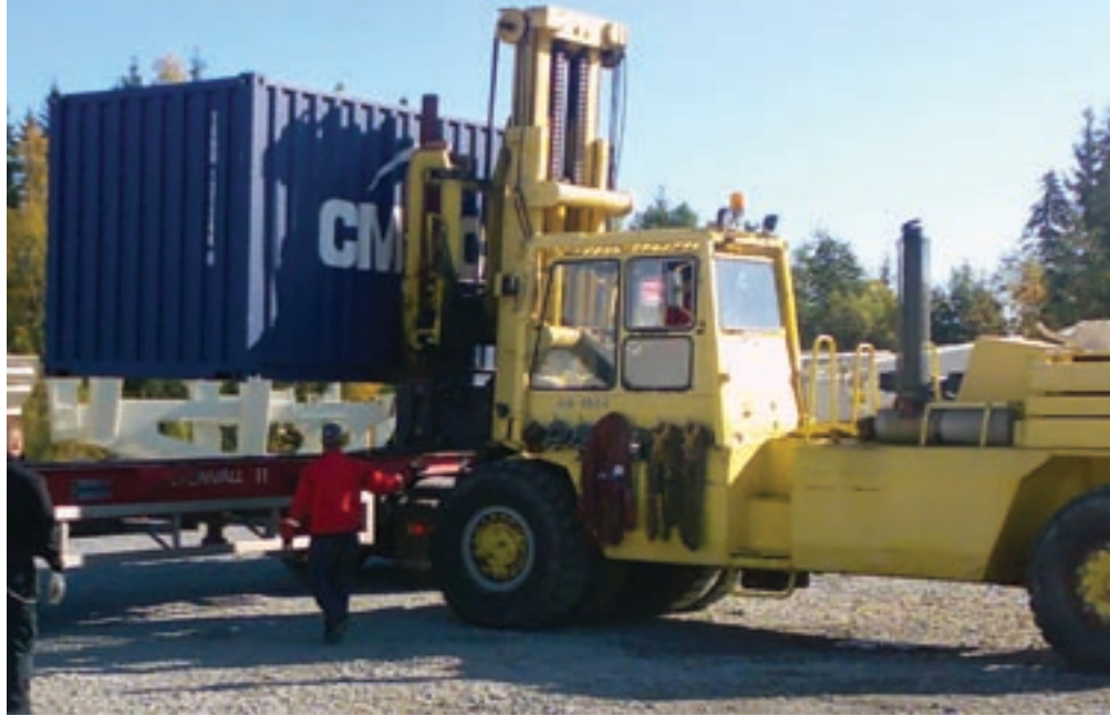
Raskasta tavaraa on helppo käsitellä siihen sopivilla koneilla. 30 tonnin kenttätrukilla liikkuvat raskaatkin taakat kevyesti.
